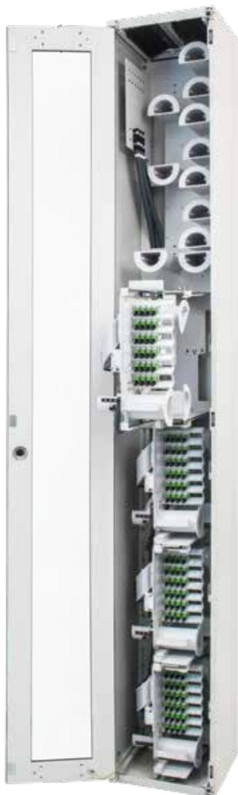
Das FIST-SODF2 Gestell kann aufgrund seiner sehr schmalen Bauform auf kleinstem Raum aufgestellt werden. Die Kabel werden in bis zu 4 Spleiß- Patch Kombimodulen aufgeteilt, je Kombimodul können 24 Fasern im Single Circuit Management (SC) auf E2000/APC FOPT-Pigtails abgeschlossen werden.
