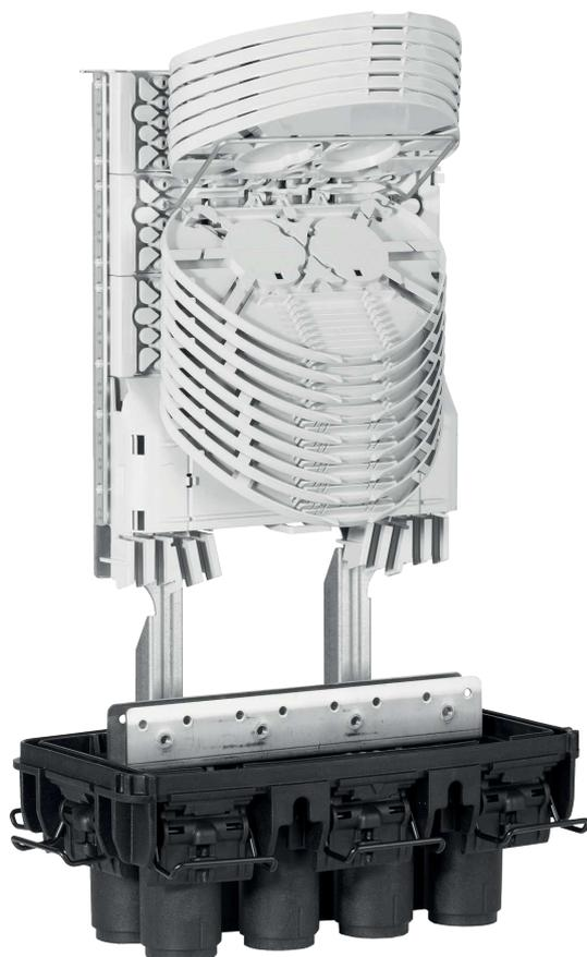
Die kleinste FIST-Verteilermuffe bietet Platz für maximal 288 Fasern. Die Schrumpf- oder Gelabdichtung der Kabeleinführungen gewähren eine hohe Dichtigkeit.
