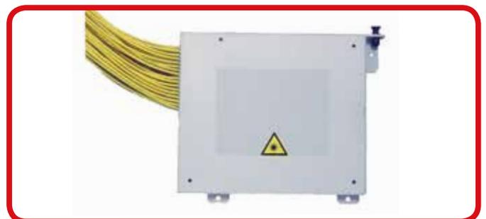
Die Splittermodule OCM6 sind für den Einsatz in BUDI-Boxen als auch im GR3 und WR2 bzw. 19" basierenden Systemgestellen konzipiert, wobei die Splitterfasern fertig konfiguriert und auf die jeweilige Gehäusegröße abgestimmt sind. Es stehen vorkonfigurierte Splittermodule mit einer Splittung von 1:4 bis 1:32 zur Verfügung.
