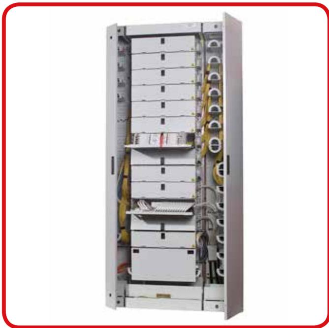
Der Hauptverteiler FIST-GR3 bietet einen einfachen Zugang von vorne zu Kabel, Pigtail und Patchkabel bei Installation und Unterhalt. Ein einzigartiges Rangierkabelmanagement ermöglicht eine Standardlänge der Patchkabel ohne Überlängen. Trennung von ankommenden und abgehenden Kabeln.
