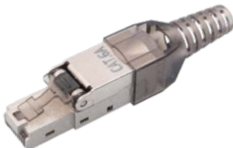
Cat.6 A ClueNet RJ-45 Stecker, AWG22-AWG24, feldkonfektionierbar
